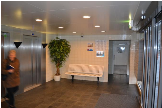
Afbeelding: Foto van een hoofdingang met een groot aantal verlichtingsarmaturen. Per uitgezet armatuur is de besparing 85 euro per jaar.
